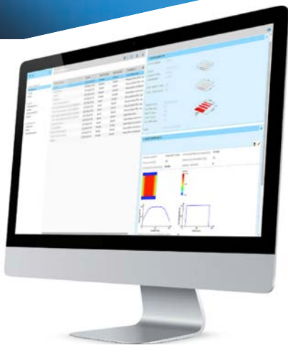
Abb. 3: Exakte Berechnung unter der Berücksichtigung aller entscheidender Parameter sind entscheidend. Dazu dienen der sterilAir Softwareprogramme, welche zusammen mit Experten der ETH-Zürich entwickelt wurden. Bei der Berechnung zur benötigten letalen Dosis spielen Parameter wie Art der Mikrobiologie, Kanaldimension, Temperatur, Luftfeuchtigkeit, Volumenstrom, Kanalbeschaffenheit sowie bestehende Filterklassen eine entscheidende Rolle. © sterilAir
